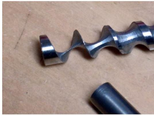
6. 先端部は削り込んで細くしていき、切り落とします。
