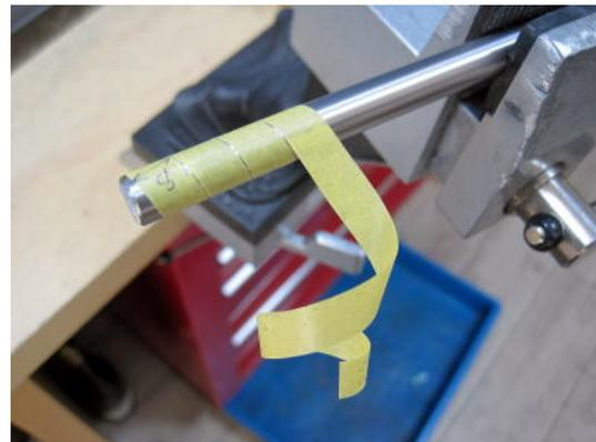
2. 直径9mmの鋼材（420J2）に8mm幅に切ったテープを螺旋状に巻き
